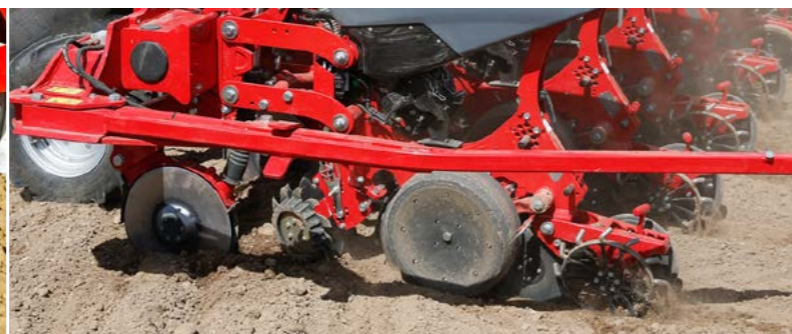
Опорный ролик со скребком, регулируемый по высоте прикапывающий ролик и ролик-семяуспокоитель, который в условиях повышенной влажности может быть демонтирован
