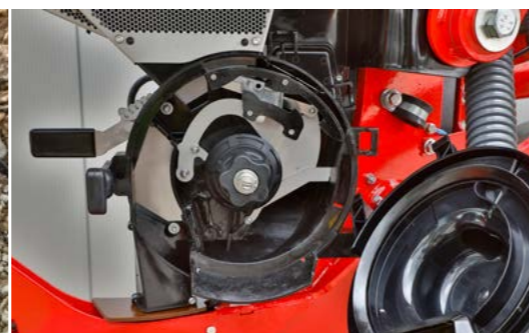
Регулируемый отсекатель направляет семя в трубку семяукладчика без возникновения центробежных сил
