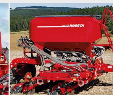
3-секц. бункер 3 800 л с 2-точ. навеской. Соотношение объемов 60:10:30
