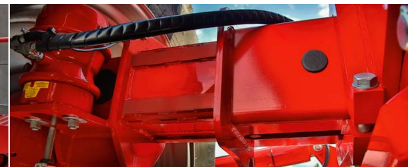
Телескопическая ось – серийно Компактность при транспортировке; меньшее уплотнение почвы в поле
