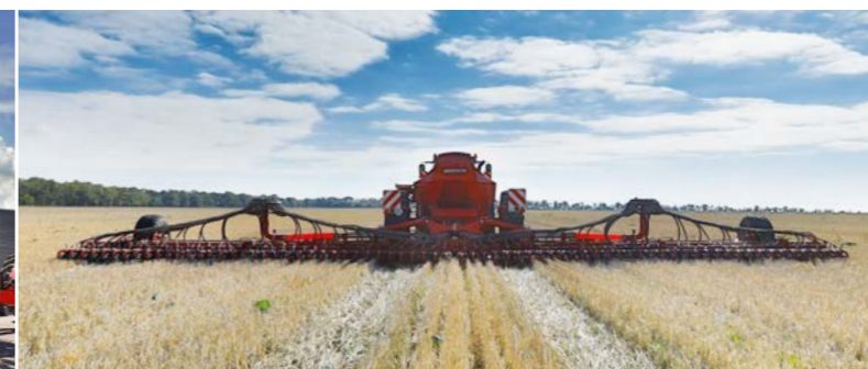
Перераспределение веса бункера на раму сеялки посредством гидравлики: Одинаково высокое давление на сошники на всей ширине захвата.
