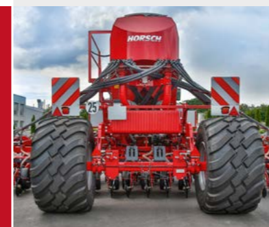
Опция: шины 710/50–26.5 для уменьшения давления на почву
