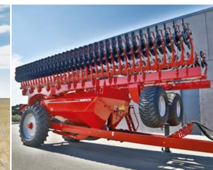
Широкопрофильные шины колес бункера Avatar 18 SD: 520/85 R 42
