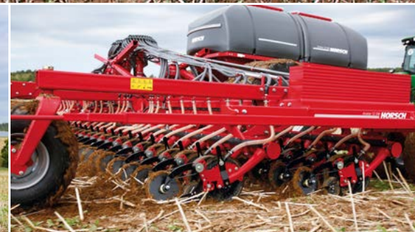
2-рядная рама с высокой проходимостью
