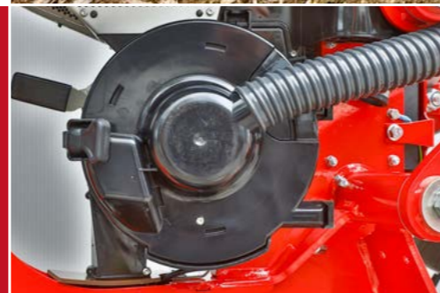
Хорошо доступный вакуумный дозатор Maestro
