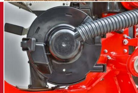
Хорошо доступный вакуумный дозатор Maestro
