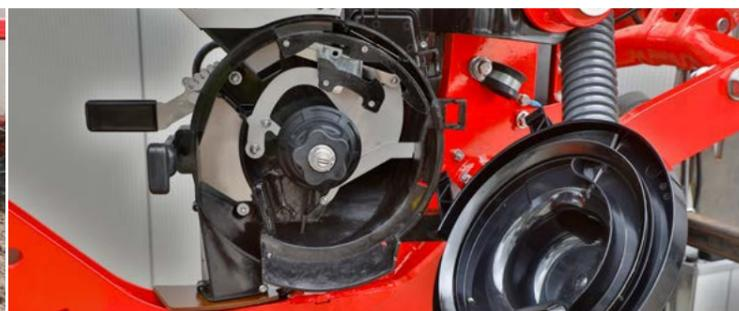
Регулируемый отсекаль направляет семя в трубку семяукладчика без возникновения центробежных сил
