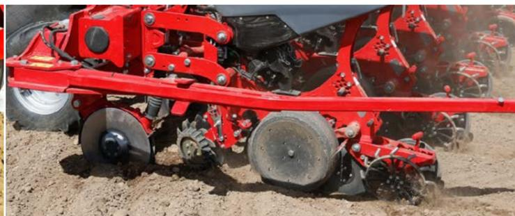
Опорный ролик со скребком, регулируемый по высоте прикатывающий ролик и ролик-семяуспокоитель, который в условиях повышенной влажности может быть демонтирован
