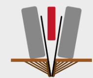
Шпоровые или пальчатые ролики продавливают уплотненный опорными роликами сошника слой почвы.
