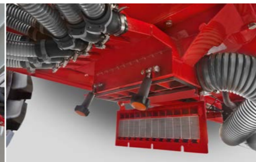
Открытый модуль распределительной системы Seed on Demand Maestro SW – вид снизу
