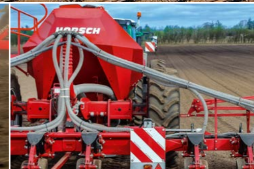
Бункер с ёмкостями для семян (2 000 л) и удобрений (7 000 л) для максимальной производительности
