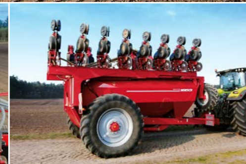
16-рядная Maestro SW при транспортировке
