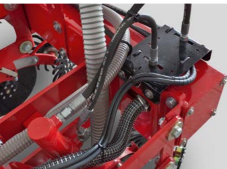
Гидравлическое регулирование давления на сошники для Maestro SW
