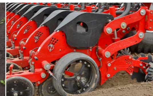
Высевающая секция с системой Seed on Demand
