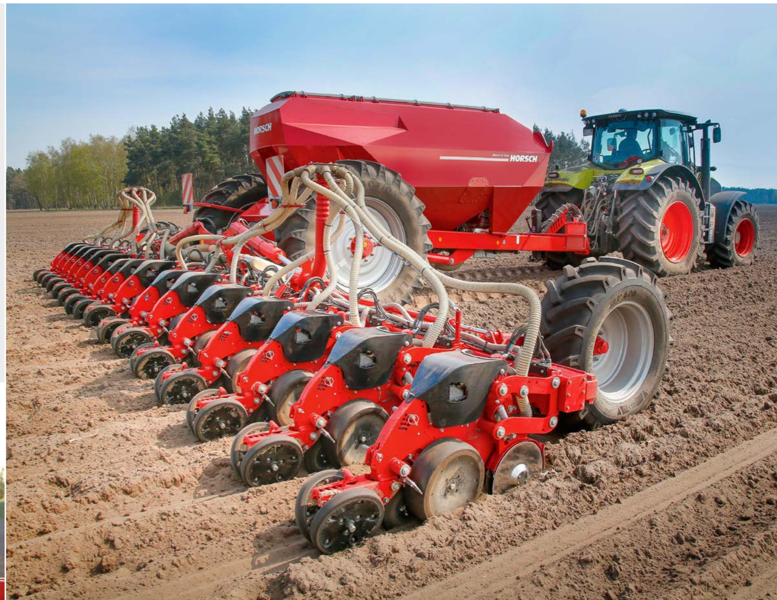
Maestro 16 SW с широкими прикатывающими роликами
