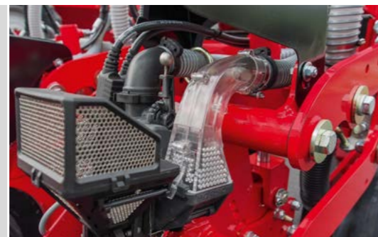
Maestro SW: Дозатор в исполнении Seed on Demand
