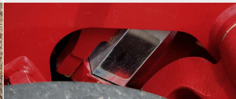
Датчик Piezo в деталях
