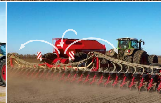
Перераспределение веса бункера на раму сеялки – с целью увеличения давления на сошники
