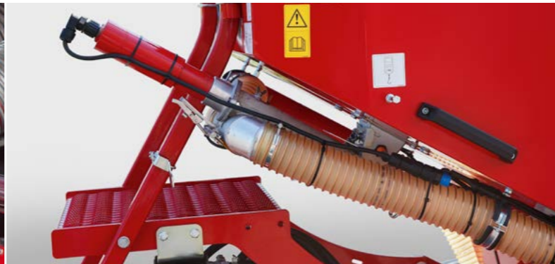
Дозатор для микрогранул (для 1-секц. бункера)
