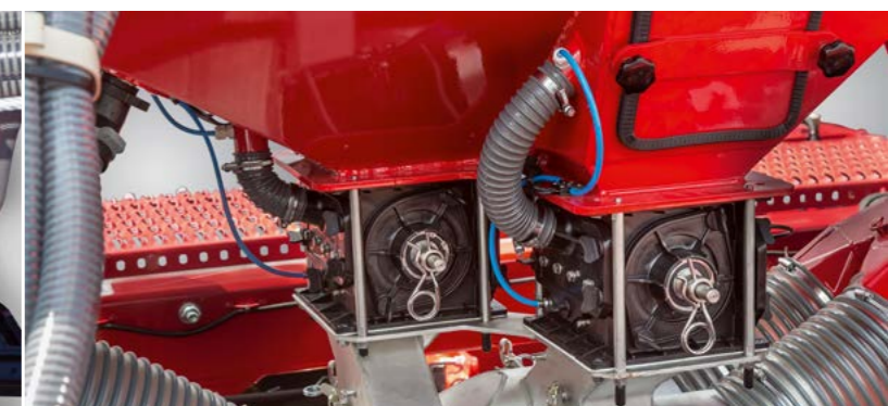
Два одинаковых дозатора Точное дозирование посевного материала и удобрений
