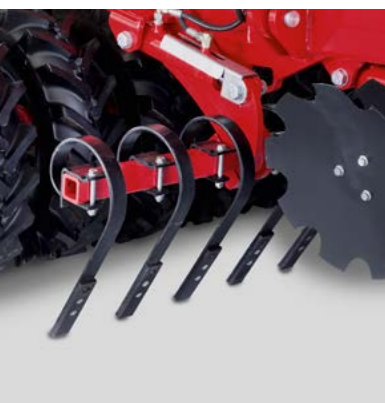
Гидравлически регулируемая выравнивающая доска Crossbar
