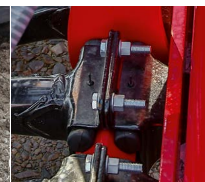
Подвеска рабочих органов на резиновых амортизаторах – Оптимальное копирование поверхности и предохранение от камней
