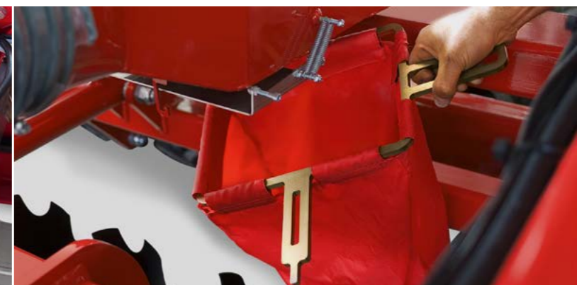
Простая калибровка Быстрая и точная калибровка нормы высева
