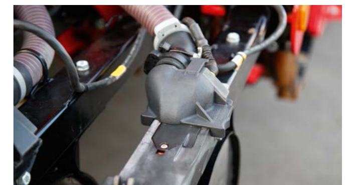
Vurpass-система для норм высева более 250 зерен/м 2 или неоднородного семенного материала
