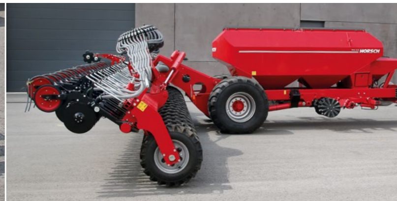
Колеса шасси служат только для транспорта
