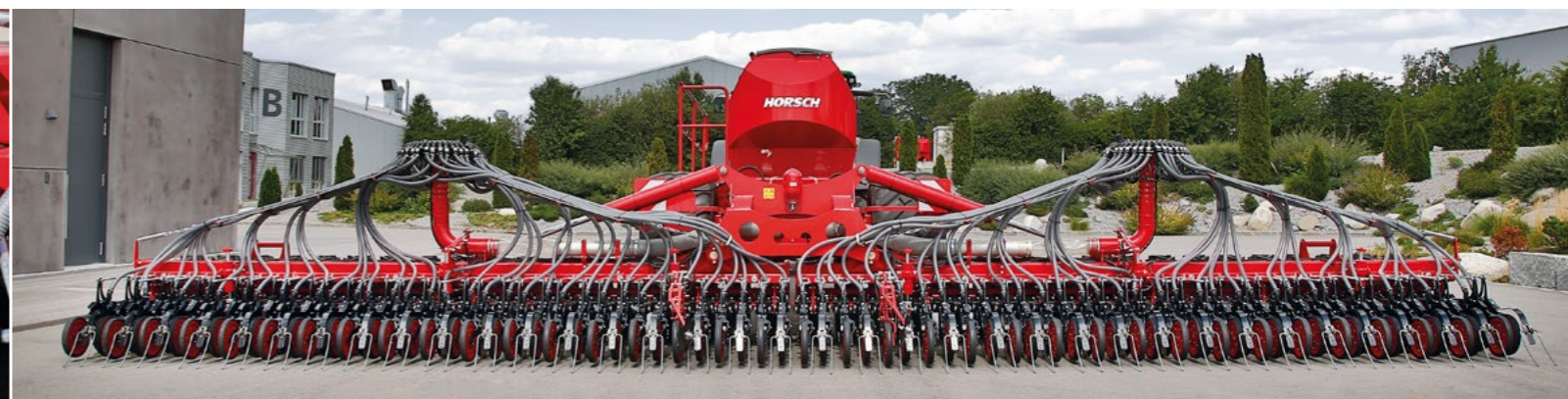
Вес бункера равномерно перераспределяется на всю площадь сеялки, обеспечивая высокую степень прижима каждого сошника
