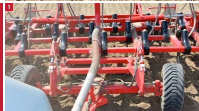
Рама посевного комплекса «Sprinter 12 HD»
