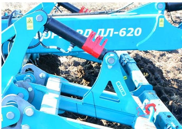
Регулировка глубины обработки осуществляется с помощью клипс, расположенных на штоках гидроцилиндров. Это позволяет удобно и быстро настроить агрегат на необходимую глубину.
