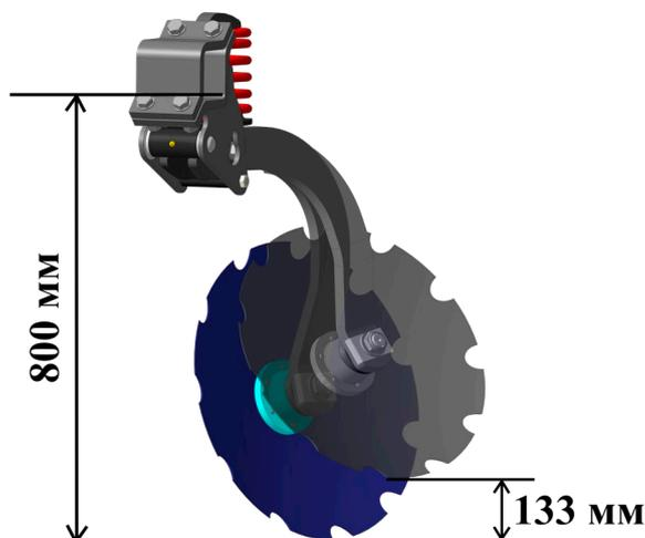
Защитное вертикальное смещение стойки 133 мм.
