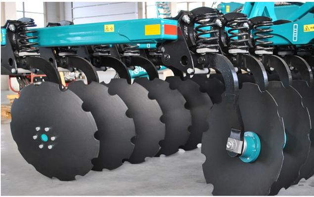
Расстановка рабочих органов позволяет получить высококачественную обработанную поверхность, с максимальным подрезанием растительных остатков и интенсивным перемешиванием. Стойки выполнены из качественной легированной высокопрочной стали. Подшипниковый узел рабочего органа необслуживаемый, и защищен от пыли и грязи кассетным уплотнителем. Сферические диски с вырезами, диаметром 610 мм. Расстояние между рабочими органами 275 мм.
