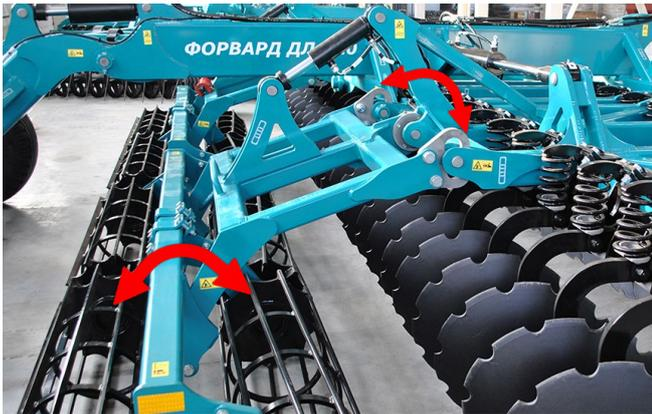
Система поперечного копирования tandemного катка расположенного на шарнирной подвеске, позволяет снизить нагрузку на раму при работе по неровным полям и улучшает копирование почвы всем агрегатом. Система продольного копирования предназначено для обеспечения равномерного давления на каждый барабан катка и позволяет получить равномерно уплотненную поверхность поля. Так же снижается динамическая нагрузка на раму при обработки полей с большим количеством камней и неровностями.
