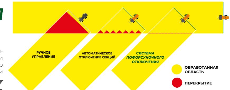
Система Пофорсуночного Отключения обеспечивает индивидуальное независимое отключение форсунок при прохождении штанги над уже обработанным участком, что обеспечивает эффективную обработку с рациональным использованием химикатов.
